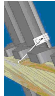
Photo 2 : Crochet d'ancrage pour chaque tuile en béton CREATON
