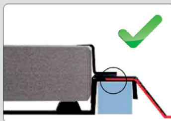
Appliquer le CREAMFLEX PIB 450 mm sur le dessus de l'onde de la plaque PV-Vario
