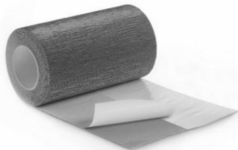
Substitut au plomb CREATON PIB Closoir universel pour mur et cheminée Largeur : 30 cm 5 mc/rouleau Couleurs : noir, rouge & plomb
