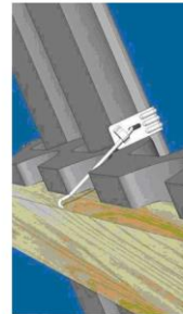
Le crochet GÖT/ HEI / VER pour les tuiles en béton CREATON
